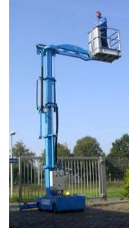
Bild: Hebebühne (das dargestellte Gitter bietet evtl. nicht ausreichend Schutz)
